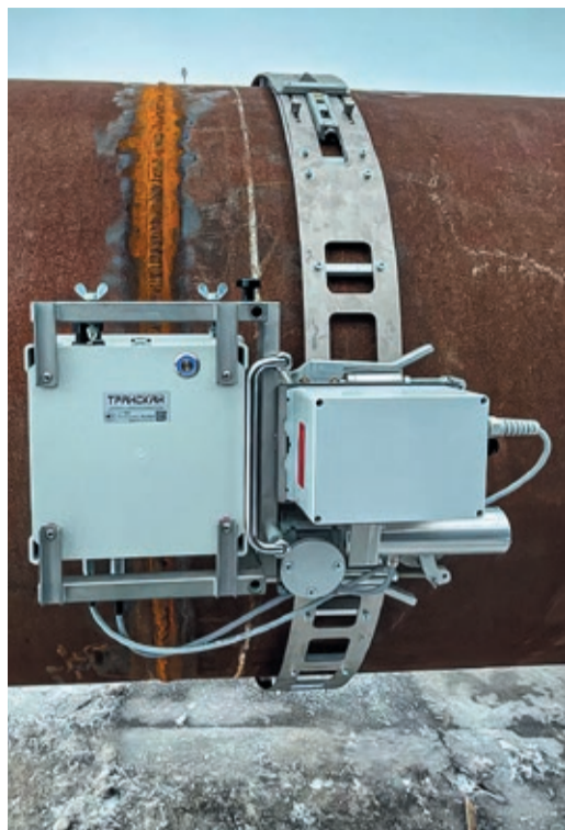
Главная «фишка» прибора — матрица, улавливающая гамма-лучи
