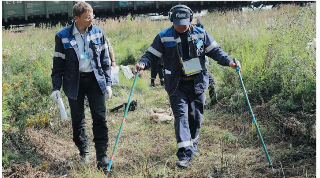
Во время поиска повреждения изоляции с помощью прибора ИПИ участники конкурса напоминали «лыжников»
