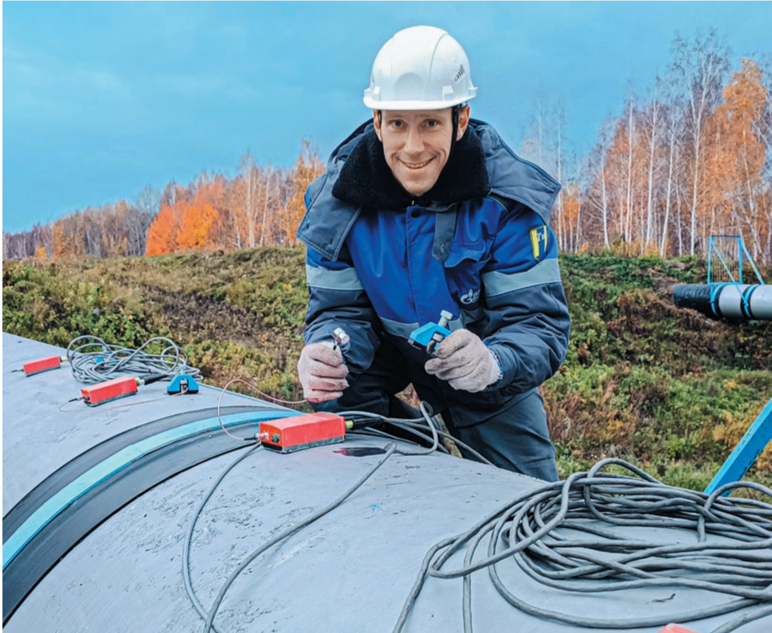
Используя метод акустической эмиссии, инженер службы неразрушающего контроля ИТЦ Александр Сафандинов проверяет на наличие микротрещин воздушный переход Уренгойской магистрали
