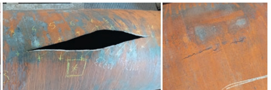
Перед разрывом трубу часто «раздувает». Тогда манометр показывает небольшое снижение давления, и это верный признак того, что испытания вот-вот закончатся
