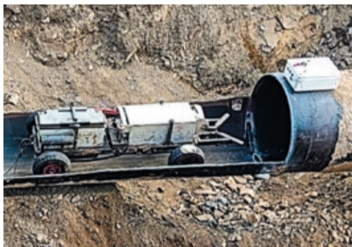
Колесный робот — самое эффективное средство для протяжки троса по подводному переходу
