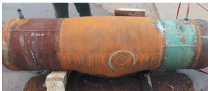
Перед разрывом трубу часто «раздувает». Тогда манометр показывает небольшое снижение давления, и это верный признак того, что испытания вот-вот закончатся
