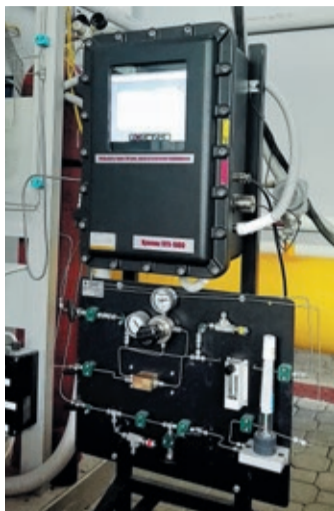
Состав газовых смесей поверяет хроматограф «Хромос»
