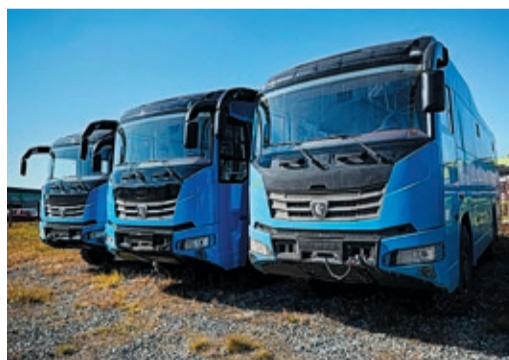
Газобаллонное, криогенное и силовое оборудование «спрятано» под красивой обшивкой
