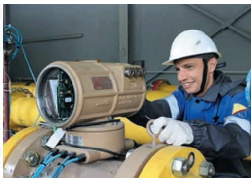
В ходе испытаний расходомера важна каждая мелочь: правильность монтажа, соблюдение параметров давления и температуры, точность обработки результатов
