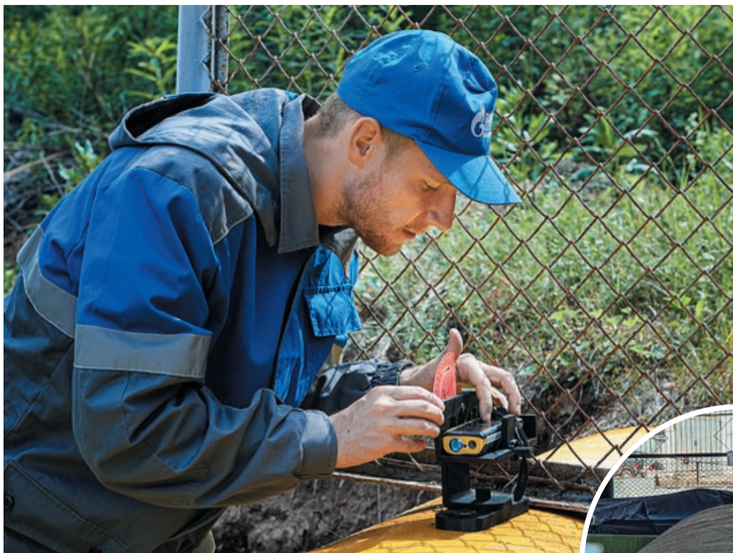
Вадим Тронза — один из авторов технологии измерения кривизны трубы с помощью лазерного дальномера
