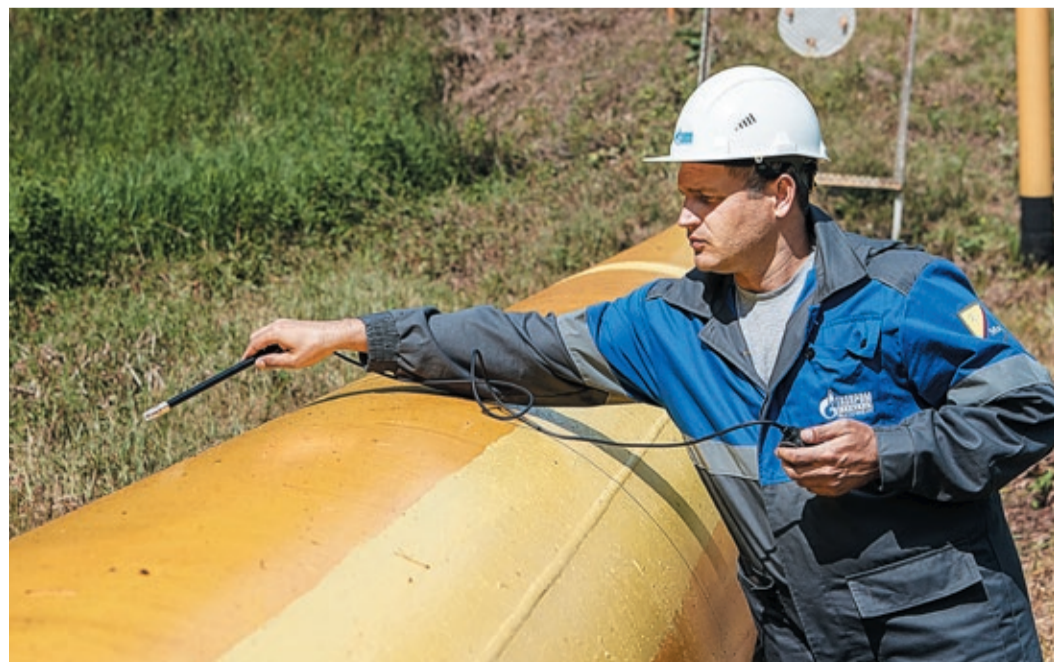
Безопасность — прежде всего: перед началом обследования начальник ЛЭС Малоистокского филиала Алексей Топорщев проверил переход на загазованность
