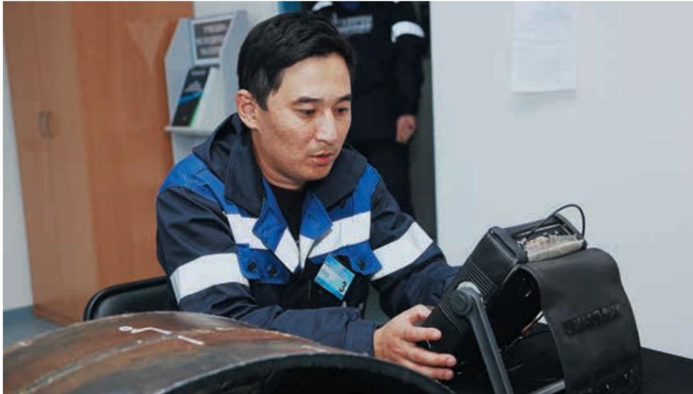
Нурдаулет Ильясов (УАВР-2) занимается ультразвуковым контролем качества сварки
