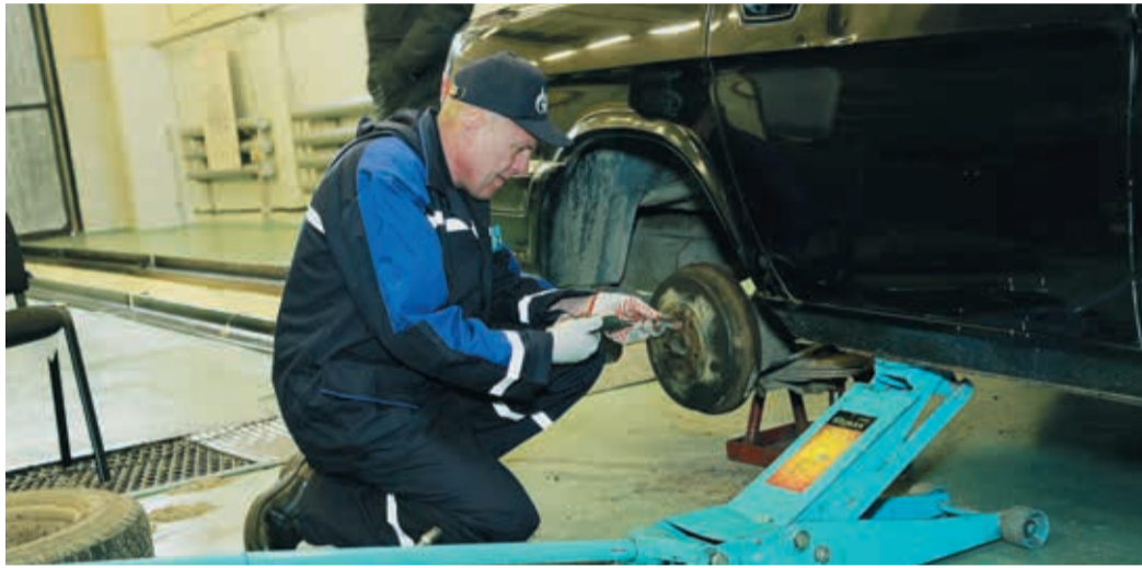
На этот раз участникам пришлось разбирать и собирать головку блока цилиндра двигателя «КамАЗа» (вверху) и менять тормозные колодки на «Волге»
